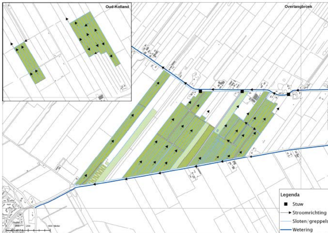
Figuur 8. Overzicht slotenpatroon met stroomrichting in Overlangbroek. Daarnaast zijn de drie stuwjes aangegeven die de afvoer van water reguleren. Verder zijn de Langbroekerwetering en Amerongerwetering aangegeven. De inzet betreft Oud-Kolland.
